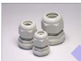
Пластиковые втулки с уплотнением и затяжными гайками, предназначенные для герметизации кабельных вводов корпусов различных приборов. Обеспечивается полная защита от проникновения в герметизируемый корпус пыли и влаги (класс защиты IP68). Гермовводы выпускаются различных размеров и могут использоваться с кабелями диаметром от 3 до 25мм. Возможна установка кабельных вводов как на корпуса для РЭА производства компании Gainta, так и на другие корпуса, требующие герметизации.
